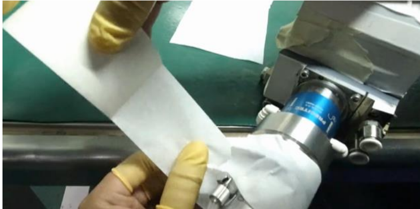
用美纹纸对输出光缆与切割头进行密封
