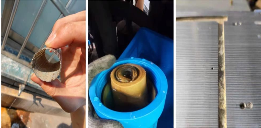
被污染后的过滤网、滤芯和激光器水路
