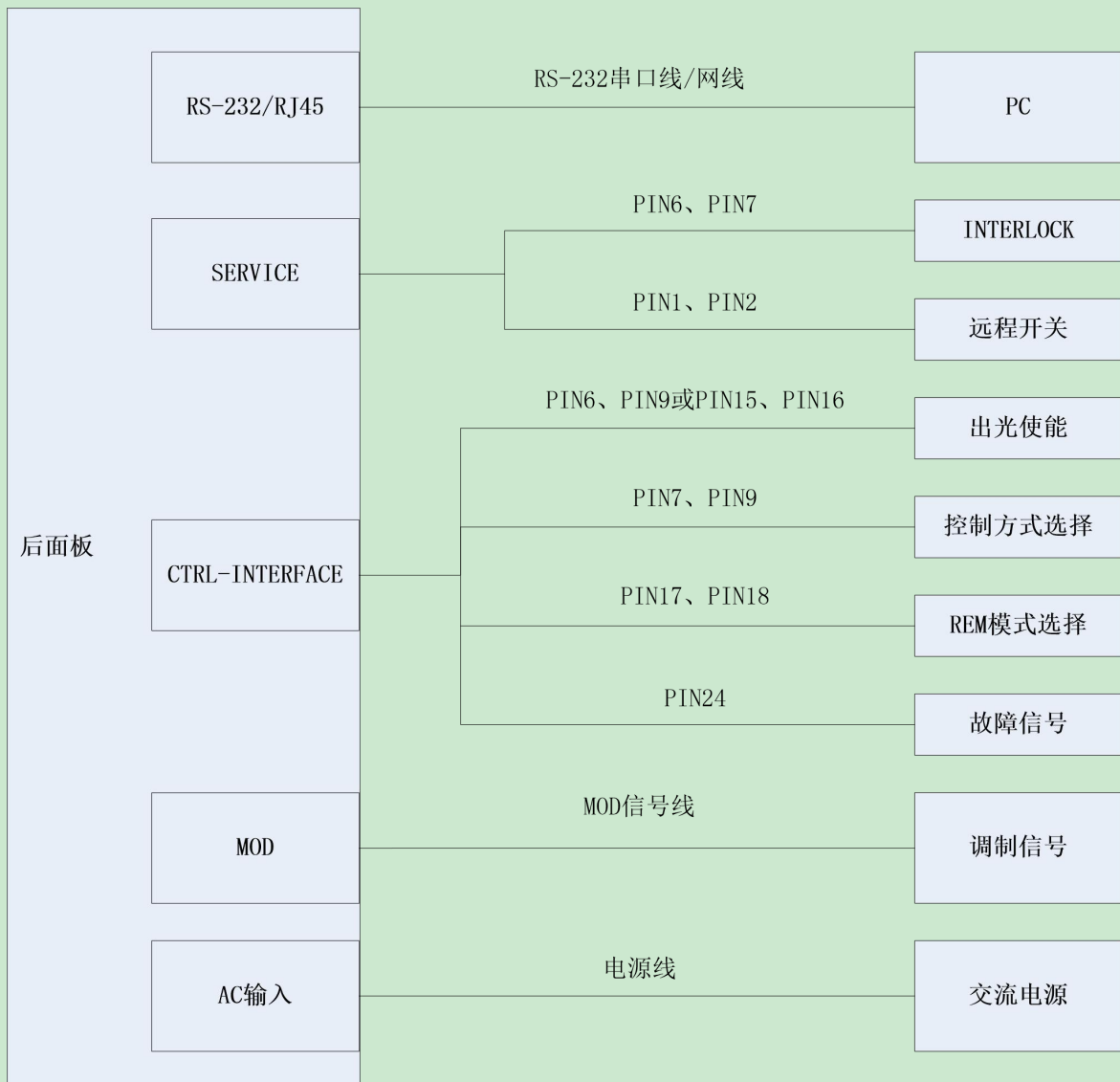
图 17 激光器外控 RS232 控制方式接线图
