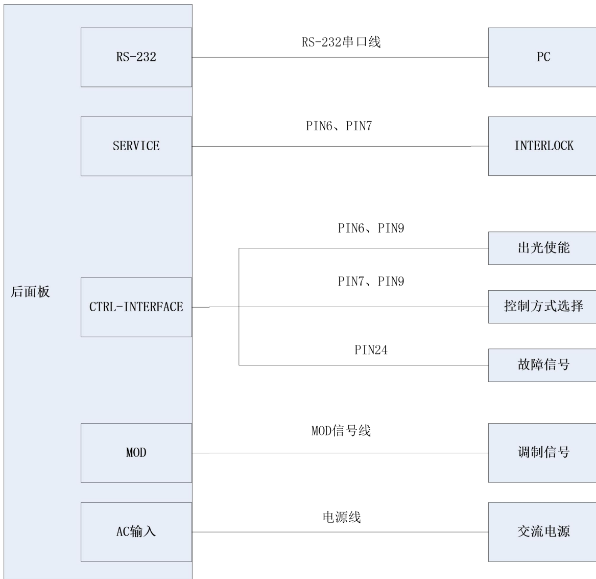
图 16 激光器外控 RS232 控制方式接线图
