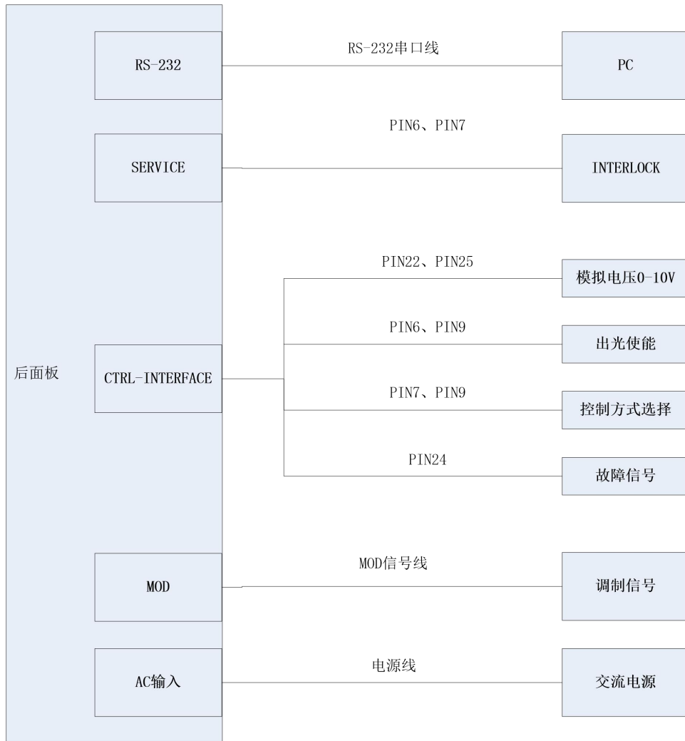
图 19 激光器外控 AD 控制方式接线图
