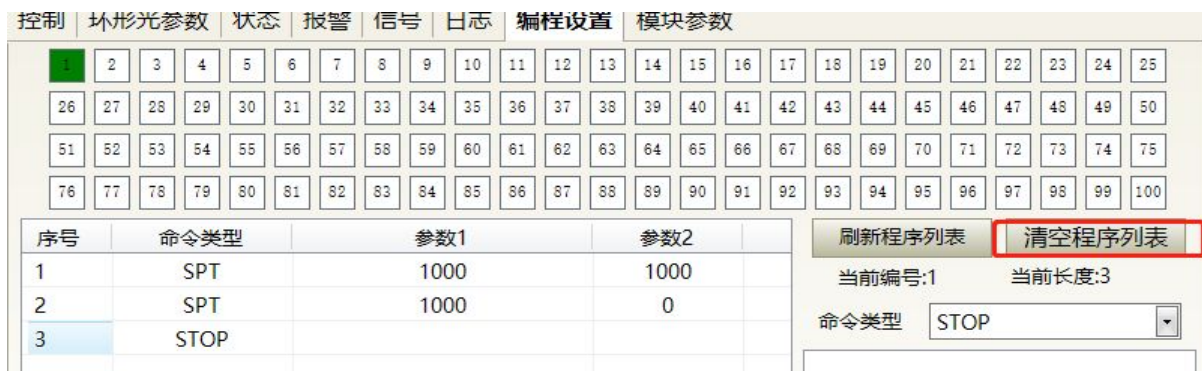
图 57 清空当前激光器波形模式下存储的所有波形操作界面
