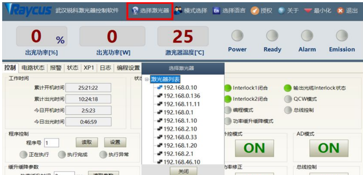
图 30 多激光器控制区显示界面
