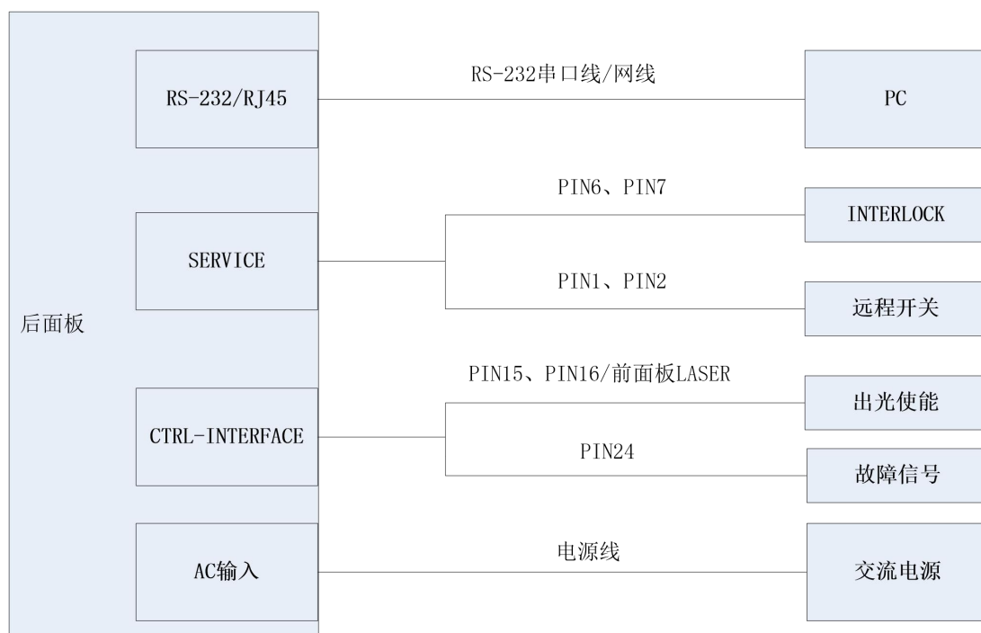
图 22 激光器内控控制方式接线图
