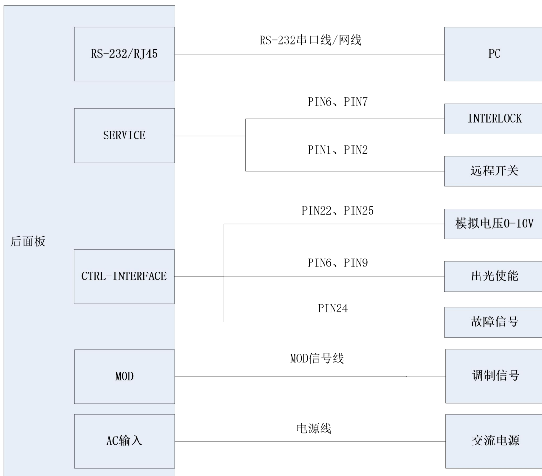
图 20 激光器外控 AD 控制方式接线图
