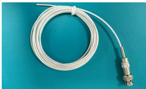
图 9 调制信号电缆线
