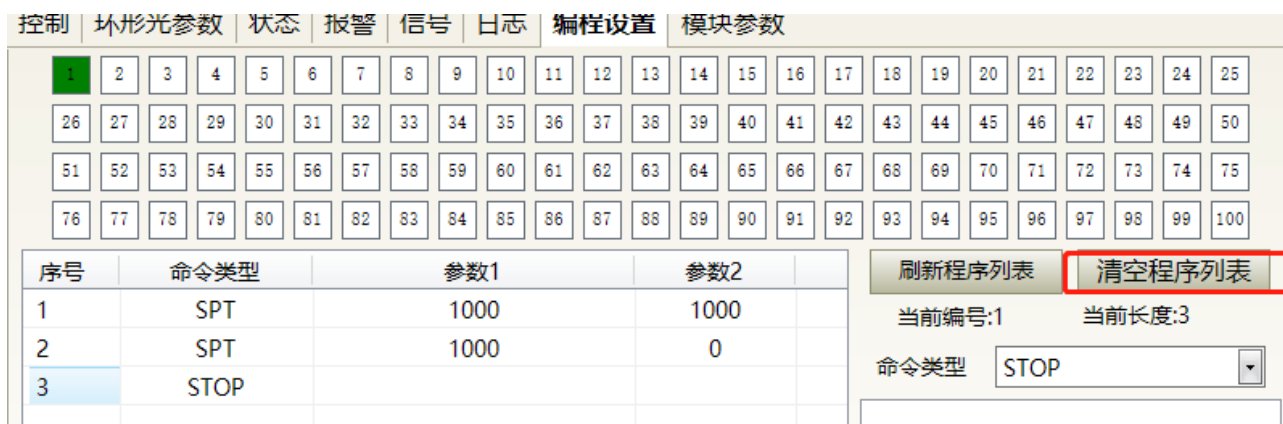
图 71 清空当前激光器波形模式下存储的所有波形操作界面
