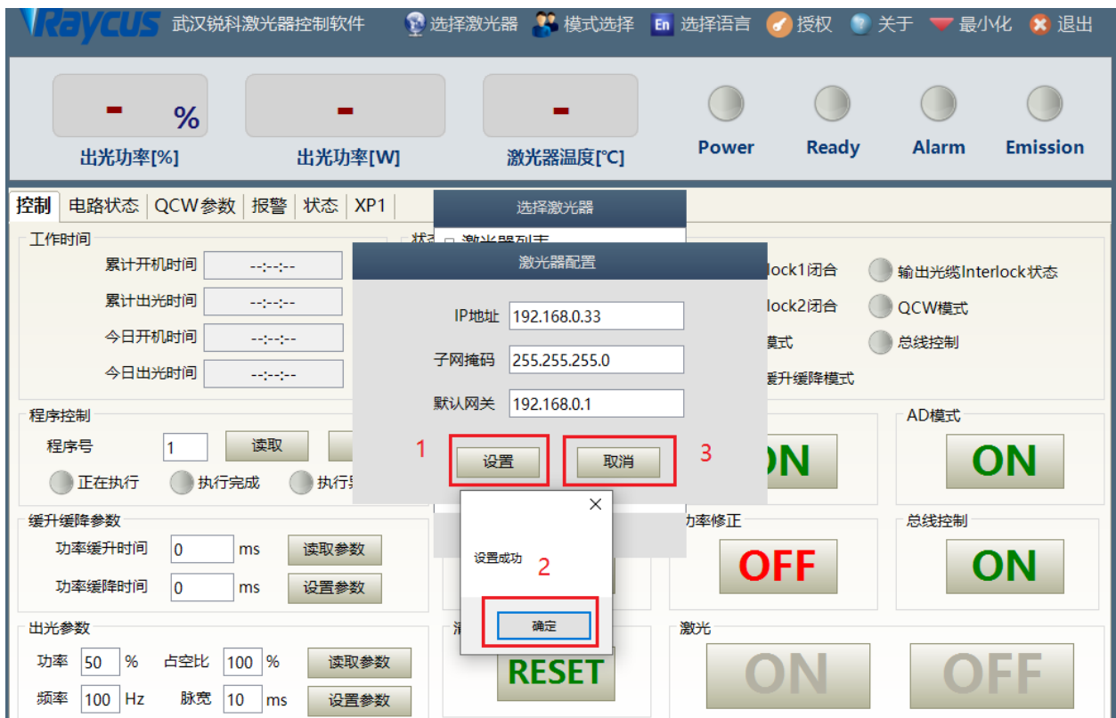
图 37 激光器修改 IP 地址步骤
