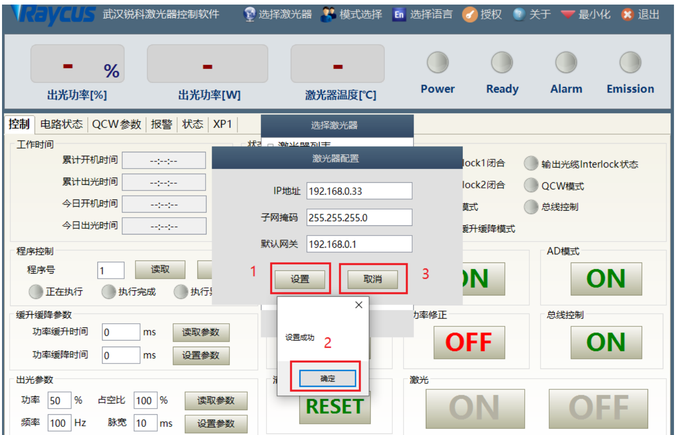
图 41 激光器修改 IP 地址步骤
