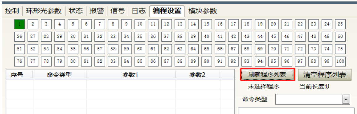
图 74 查看当前激光器内部存储的波形条数操作界面
