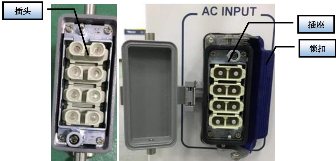
图 15 C6000H 电源线插头、插座实物图
