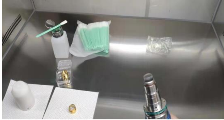
图 9 取下光缆上的 A 款端盖
