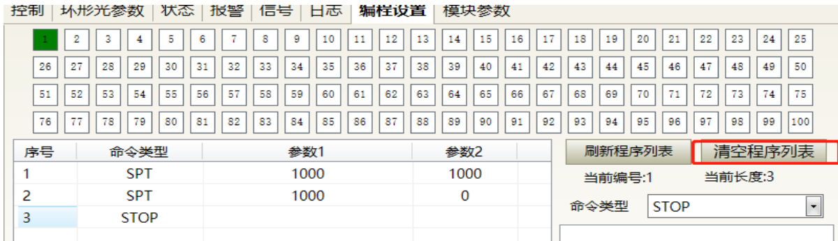
图 76 清空当前光器波形模式下存储的所有波形操作界面
