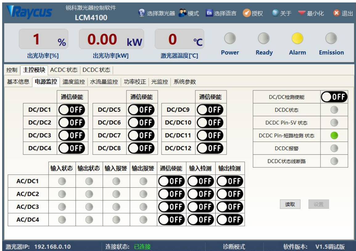
图 16 主控模块电源监控界面
