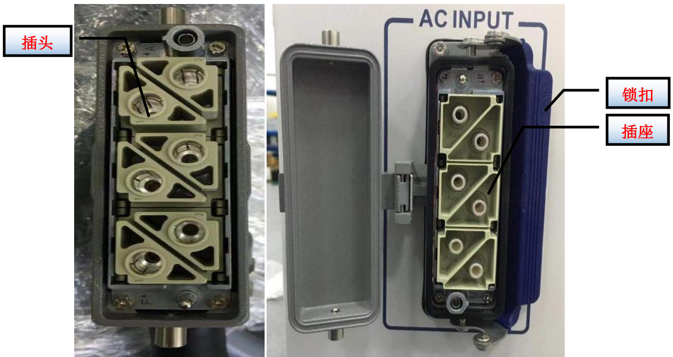
图 15 RFL-C30000XZ 电源线插头、插座实物图
