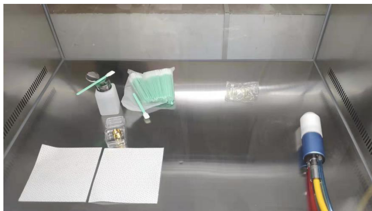
图 7 放置于开启抽风的洁净工作台中的输出光缆
