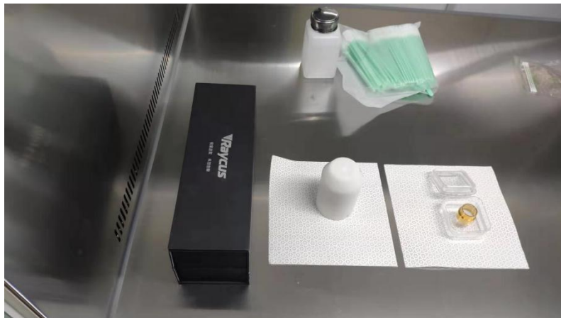
图 10 客户需要保留的配件：黑色保护盒、白色防尘盖、A 款端盖
