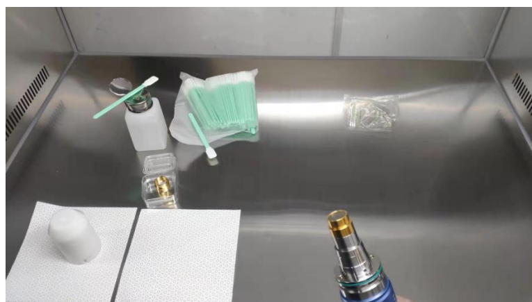
图 7 取下白色防尘盖的输出光缆
