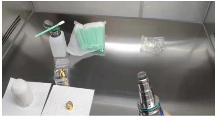
图 8 取下光缆上的 A 款端盖
