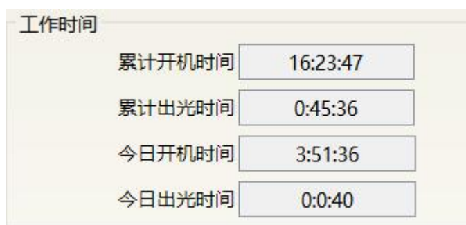
图 41 激光器累计工作时间显示界面
