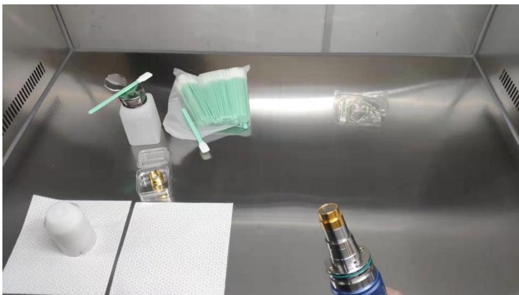
图 7 取下白色防尘盖的输出光缆
