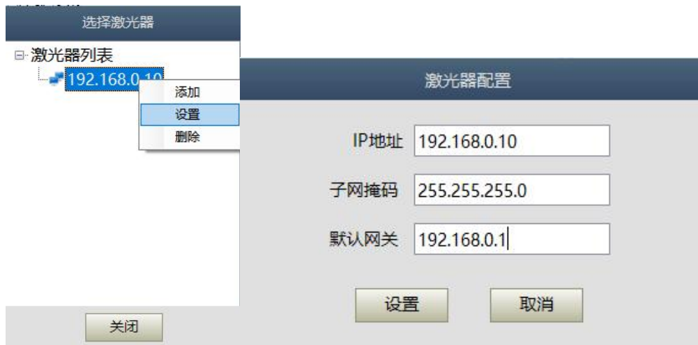
图 39 修改激光器的 IP 地址
