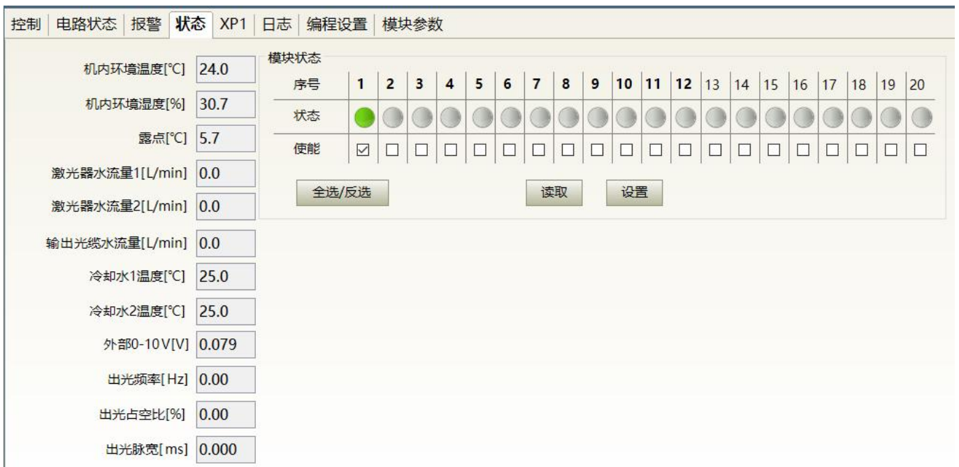
图 47 激光器参数显示区显示界面
