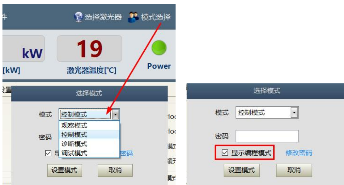
图 49 激光器工作模式选择显示区显示界面
