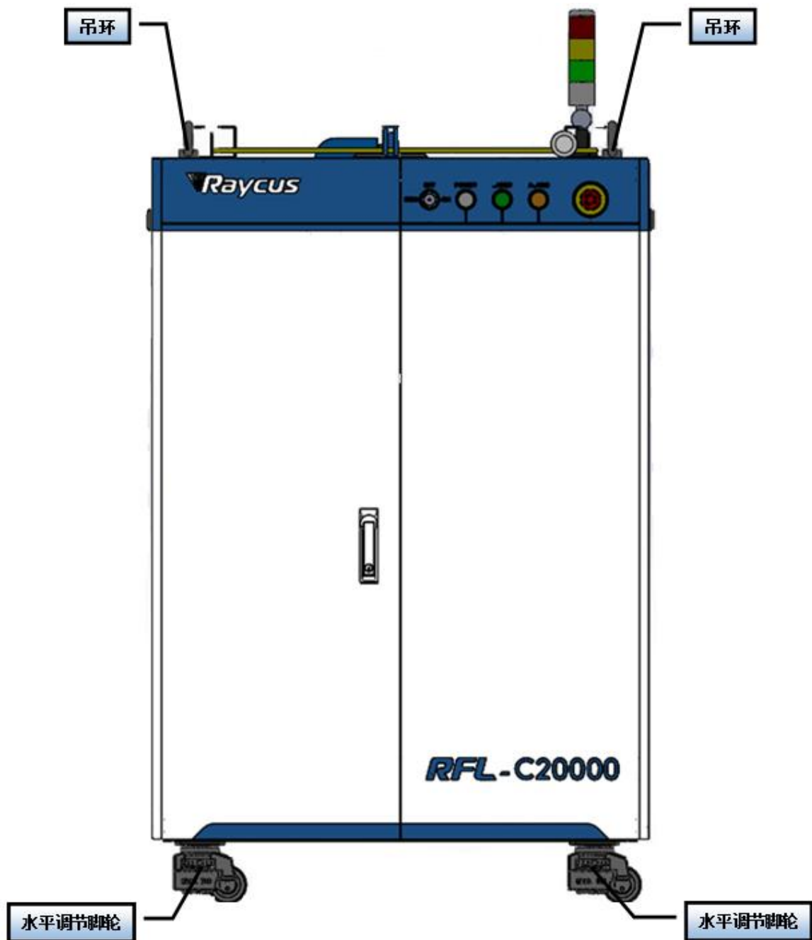
图3 激光器顶部吊环及底部水平调节脚轮
