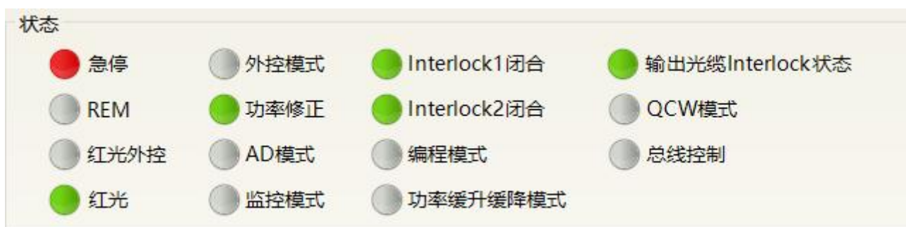
图 42 激光器工作状态显示区示意图
