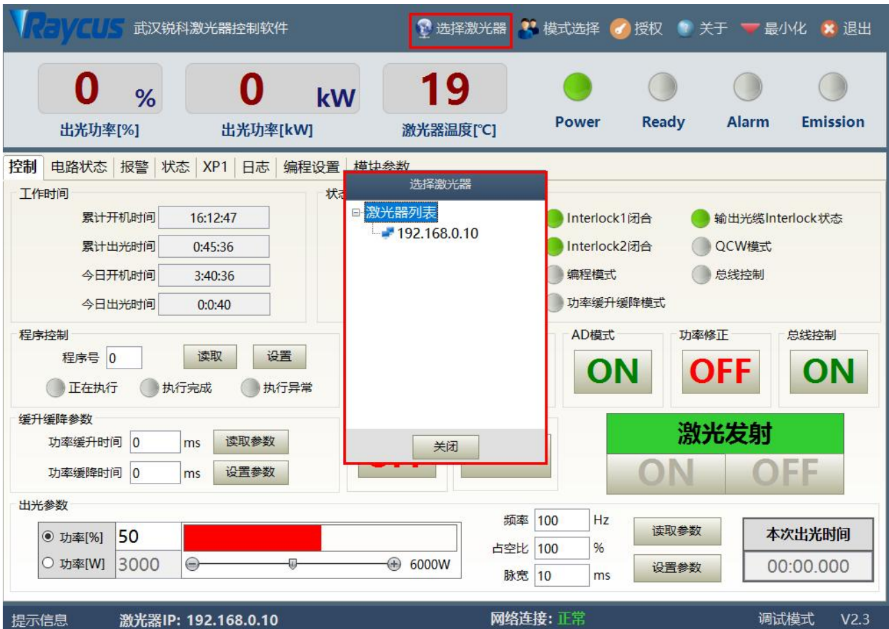
图 36 多激光器控制区显示界面
