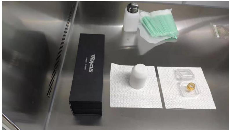
图 9 客户需要保留的配件：黑色保护盒、白色防尘盖、A 款端盖
