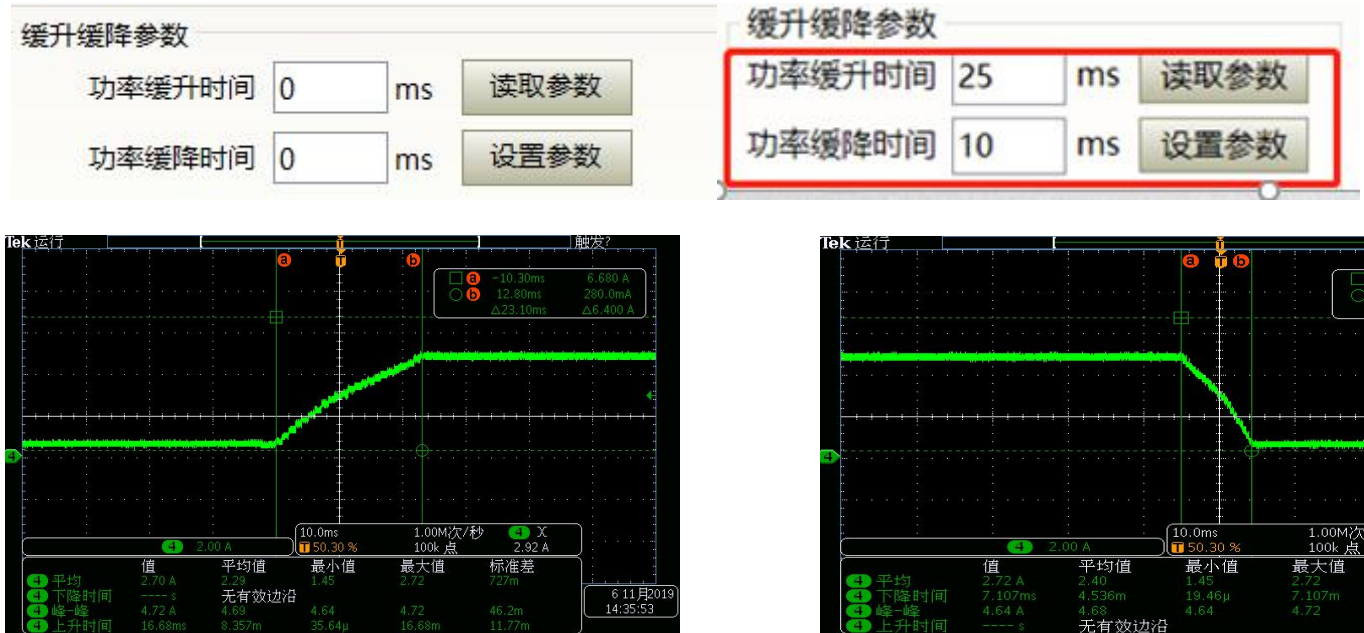
图 44 功率缓升缓降设置区显示界面及实测波形
