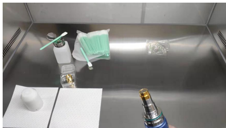
图 8 取下白色防尘盖的输出光缆
