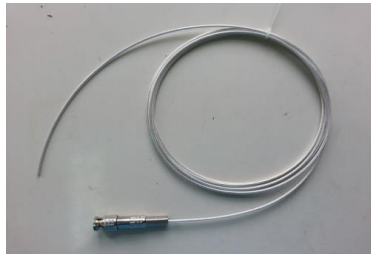
图 15 调制信号电缆线
