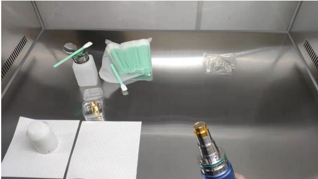
图 14 取下白色防尘盖的输出光缆
