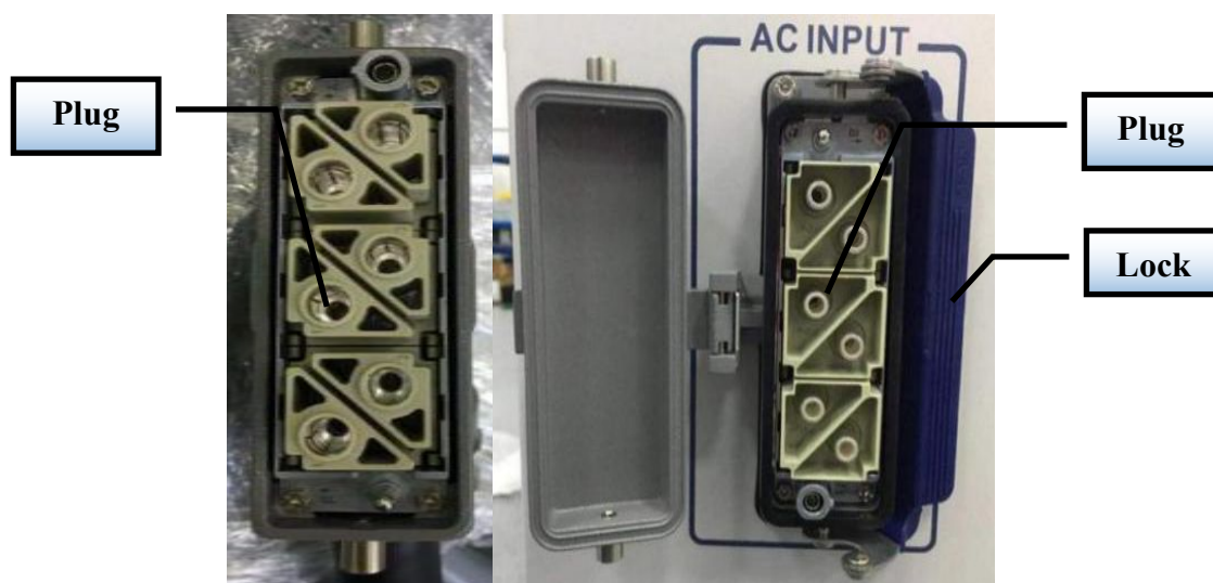
(d) Power cord plug and socket of 15kW laser
